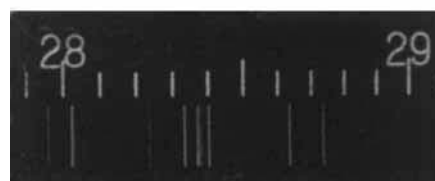
Abb. 4. Spektrum eines synthetisch hergestellten Blei-Zinn-Gelbs. Bleilinien auf 2833, 2873, Zinnlinien auf 2840 und 2863 Å.
